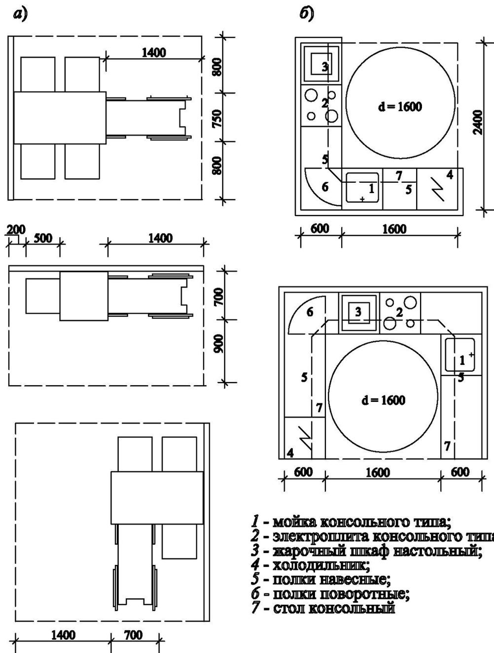
**Рисунок А.10 - Функциональная зона у обеденного стола (а) и Г- и П-образное размещение кухонного фронта оборудования (б) для семьи с инвалидом-колясочником**
