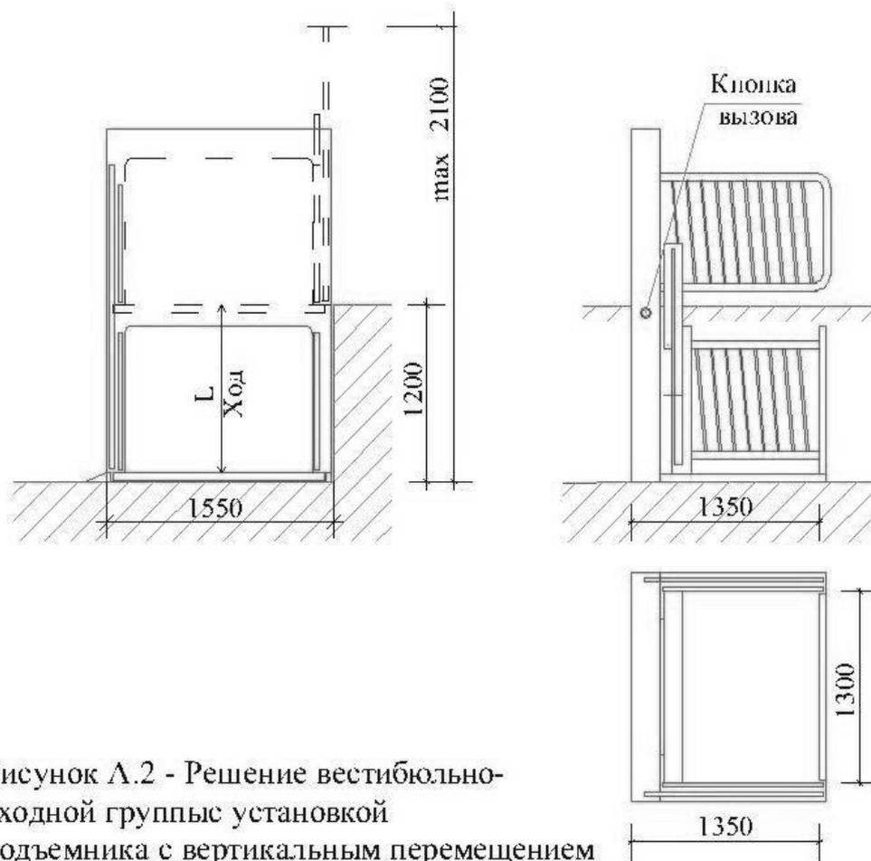
Рисунок А.2 - Решение вестибюльно-входной группы установкой подъемника с вертикальным перемещением
